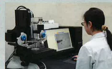
マイクロマニピュレーターによる微小物(μm order)の採取・解析 Sampling and analysing the micro object(μm order) by using the micromanipulator
